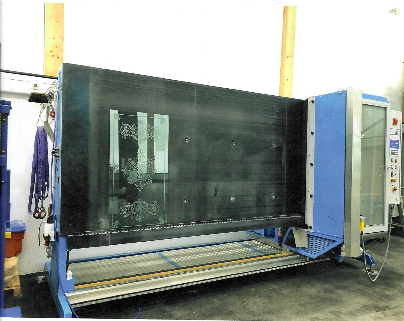
Der Satiniermaschine können verlaufende Satinierungen oder «Fade Out – Flächen», matte Oberflächen, die klar auslaufen, produziert werden.
